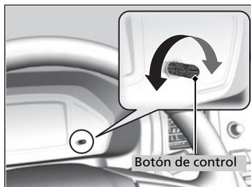
Cuando el modo de alimentación está en CONTACTO, puede usar el control de control de brillo para ajustar el brillo del tablero de instrumentos.
