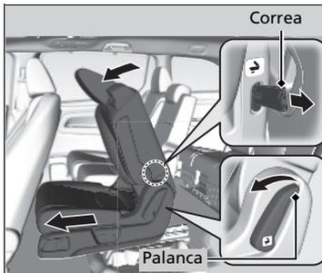
Al tirar de la palanca de ajuste o de la correa de liberación, el respaldo del asiento exterior de la segunda fila se inclina hacia delante.
