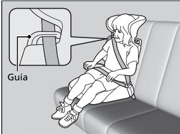
Hay disponible un respaldo para un cojín elevador determinado. Instale el respaldo en el cojín elevador y ajústelo al asiento del vehículo siguiendo las instrucciones del fabricante del cojín elevador. Asegúrese de que el cinturón de seguridad se pasa correctamente a través de la guía del hombro del respaldo y que el cinturón no toca y cruza el cuello del niño.
