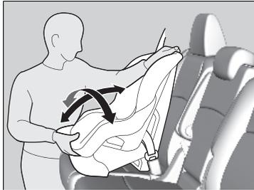
5. Tómese la parte del hombro del cinturón de seguridad cerca de la hebilla y tire hacia arriba para eliminar cualquier holgura de la parte de la cadera del cinturón.
