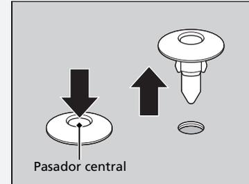
Empuje el pasador central para bloquear el clip. A continuación, introduzca el clip en el orificio y presione el pasador central hasta que quede plano.
