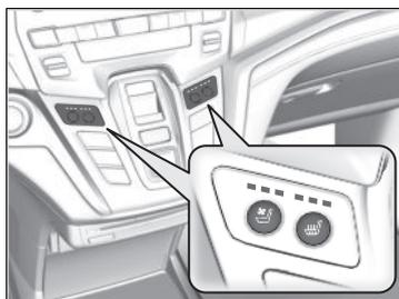
El modo de potencia debe estar en CONTACTO para utilizar los asientos térmicos y la ventilación.
