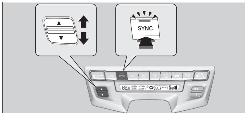
Es posible ajustar la temperatura sincrónicamente para el compartimento delantero y el de pasajeros trasero en modo de sincronización.
