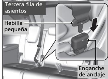
1. Saque la hebilla pequeña del cinturón de seguridad y la hebilla de cada ranura de sujeción del techo.
