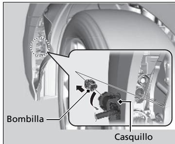
1. Gire el volante por completo hacia el lado opuesto a la luz que va a sustituir.
