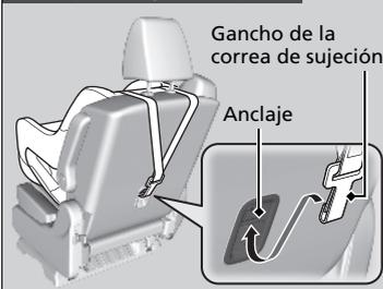
3. Coloque la cabecera en su posición más alta, dirija la correa de sujeción fuera de/entre las patas de la cabecera y sujete el gancho de la correa de sujeción en el anclaje.
