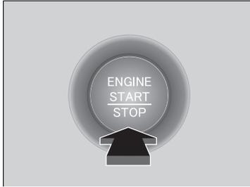
3. Pulse el botón **ENGINE START/STOP** sin pisar el pedal del acelerador. El motor arrancará hasta que se encienda.
