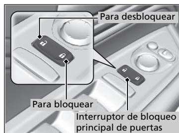
Pulse el interruptor de bloqueo principal tal y como se muestra para bloquear o desbloquear todas las puertas, la compuerta trasera y el depósito de combustible.
