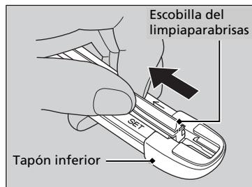
5. Tire del extremo de la escobilla del limpiaparabrisas en la dirección de la flecha en la imagen hasta que salga del tapón del soporte.
