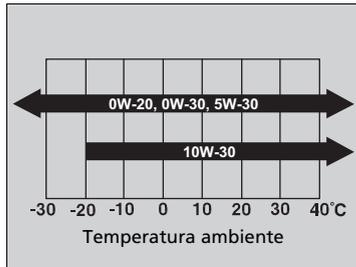
Utilice aceite de motor original de Honda u otro aceite del motor comercial del grado de viscosidad adecuado para la temperatura ambiente según se indica.
