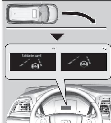
La cámara frontal detrás del espejo retrovisor supervisa las marcas de carril de los lados izquierdo y derecho (blancas o amarillas). Si el vehículo se acerca demasiado a las marcas del carril detectadas sin que se haya activado un intermitente, el sistema, además de emitir una alerta visual, aplica par a la dirección y alerta con vibraciones rápidas del volante, para ayudarle a permanecer dentro del carril detectado.
