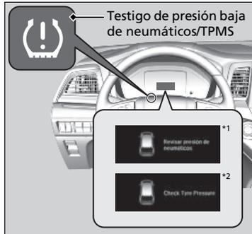
Controle la presión de los neumáticos mientras conduce. Si la presión de los neumáticos del vehículo se reduce significativamente, el indicador de presión baja de neumáticos/TPMS se enciende y aparece un mensaje en la interfaz de información al conductor.
