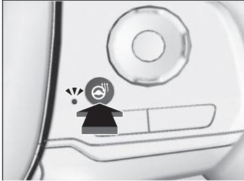
La modalidad de alimentación debe estar en CONTACTO para utilizar el volante térmico.
