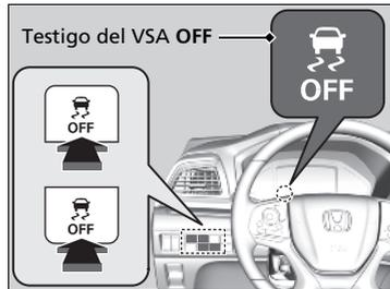
Este botón se encuentra en el panel de controles del lado del conductor. Para desactivar parcialmente la función/características de VSA, mantenga presionado hasta que escuche un aviso acústico.
