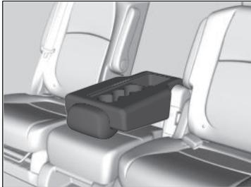
Tire hacia arriba de la correa y pliegue hacia abajo el respaldo del asiento central para usarlo como reposabrazos.
