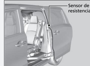
No toque el sensor de resistencia situado en el extremo delantero de la puerta deslizante eléctrica. No dañe el sensor. La puerta deslizante eléctrica puede no funcionar correctamente.
