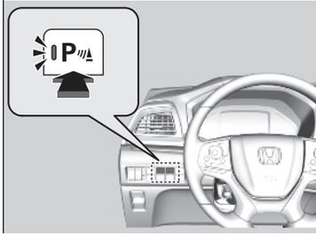
Con la modalidad de alimentación en CONTACTO, oprima el botón del sistema de sensores de estacionamiento para activarlo o desactivarlo. El indicador del botón se enciende cuando el sistema está activado.
