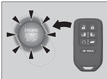
1. Toque la parte central del botón **ENGINE START/STOP** con el símbolo **H** del control a distancia de acceso sin llave mientras parpadea el botón **ENGINE START/STOP**. Los botones del control a distancia de acceso sin llave deben estar orientados hacia usted.
