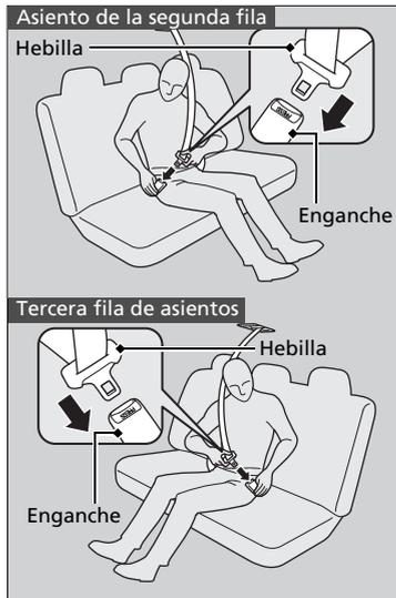
3. Introduzca la hebilla en el enganche. Ajuste adecuadamente el cinturón de seguridad de la misma forma que ajusta el cinturón de seguridad de tres puntos.
