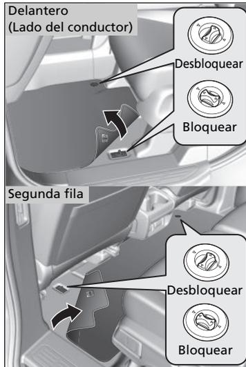
Las alfombras del piso delanteras y de la segunda fila quedan enganchadas sobre los anclajes del piso, lo que impide que se deslicen hacia delante. Para desmontar una alfombra para limpiarla, gire los controles del anclaje a la posición de desbloqueo. Cuando vuelva a montar la alfombra después de limpiarla, gire los controles a la posición de bloqueo.
