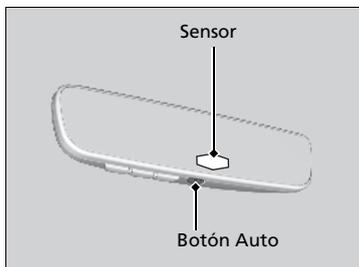
Al conducir de noche, el retrovisor y los retrovisores eléctricos de las puertas con atenuación automática\* reducen el reflejo de los faros del vehículo que circula detrás. Pulse el botón AUTO para activar y desactivar esta función. Al activarla, se enciende el testigo AUTO.
