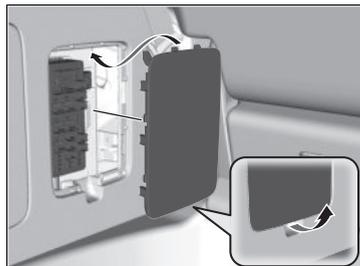
Las ubicaciones de los fusibles se muestran en la cubierta de la caja de fusibles.
