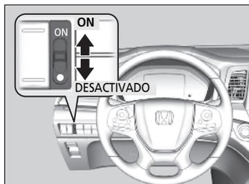
**Funcionamiento automático:** Seleccione la posición **ON** del interruptor principal de la puerta corredera.
