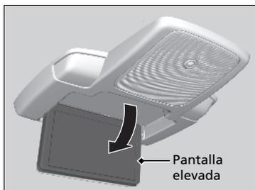
Tire de la pantalla hacia abajo hasta el primer o segundo tope, hasta que quede bloqueada.
