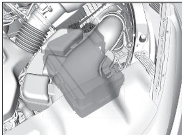
El estado de la batería está controlado por un sensor colocado en su terminal negativo. Si se produce algún problema con este sensor, la interfaz de información del conductor mostrará un mensaje de advertencia. Si ocurre esto, haga que revisen el vehículo en un concesionario.
