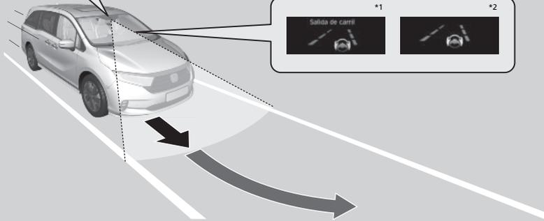
Si se activa el intermitente para cambiar de carril, el sistema queda suspendido y se reanuda cuando se apaga el intermitente.
