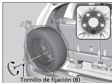
**4.** Instale el soporte y el tornillo de fijación (A) en el punto de acoplamiento, y apriete el tornillo.
