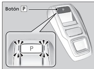
Estacione su vehículo en un lugar seguro con la modalidad de alimentación en CONTACTO; a continuación, aplique el freno y pulse el botón **P** para colocar la caja de cambios en Estacionamiento. Los indicadores a los lados del botón **P** se encienden.
