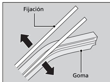
4. Desmonte las fijaciones de la escobilla del limpiaparabrisas y móntelas en una escobilla de goma nueva.
