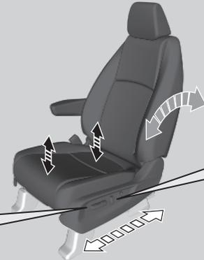
Ajuste de la inclinación del respaldo
