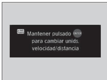
Permite ajustar el velocímetro y las unidades de medida que se muestran para que aparezcan en km/h y mph.
