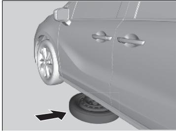
**7.** Coloque el neumático compacto de repuesto (con la llanta hacia arriba) debajo del vehículo, cerca del neumático que va a sustituir.
