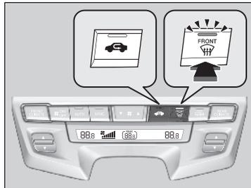
Al pulsar el botón
