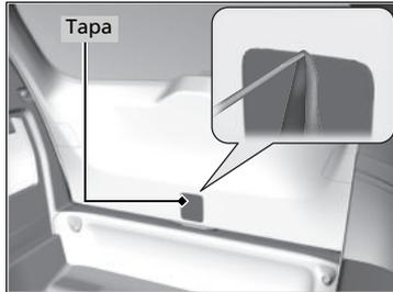
1. Con un desarmador de punta plana retire la tapa de la parte trasera del portón trasero.
