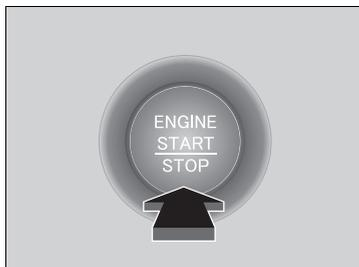
2. Pise el pedal de freno y pulse el botón **ENGINE START/STOP** antes de que transcurran 10 segundos desde el aviso acústico y de que el botón **ENGINE START/STOP** cambie de parpadeo a encendido.
