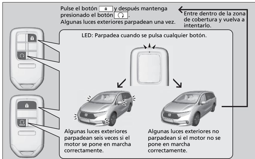
Cuando se arranca de forma remota, el motor se apaga automáticamente tras 10 minutos en ralentí o si no se ha pisado el pedal de freno a la vez que se ha presionado el botón **ENGINE START/STOP**.
