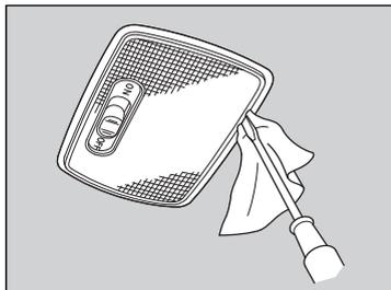
1. Haga palanca en el borde de la tapa con un desarmador de punta plana para desmontarla.
