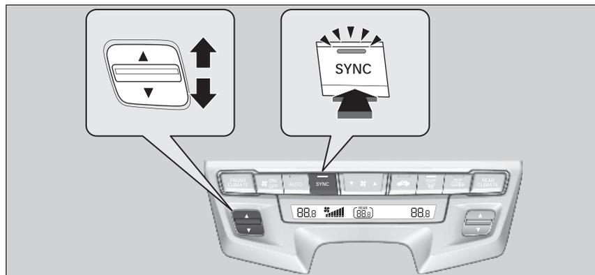
Es posible ajustar la temperatura sincrónicamente para el lado del conductor, del acompañante y de los asientos traseros en modo de sincronización.
