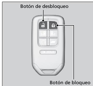
**Para abrir:** Pulse el botón de desbloqueo y, en 10 segundos, púlselo de nuevo y manténgalo presionado. **Para cerrar\*:** Pulse el botón de bloqueo y, en 10 segundos, púlselo de nuevo y manténgalo presionado. Si las ventanillas se detienen en la posición intermedia, vuelva a repetir este procedimiento.
