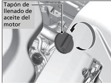
1. Desenrosque y retire el tapón de llenado de aceite del motor.
