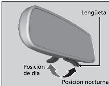
Gire la lengüeta para cambiar la posición. La posición nocturna contribuye a reducir el deslumbramiento de los faros de los vehículos posteriores después del crepúsculo.
