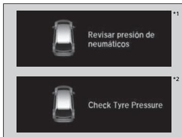
**Revisar presión de neumáticos<sup>\*1</sup>/Check Tyre Pressure<sup>\*2</sup>** aparece cuando un neumático tiene una presión significativamente baja. El neumático concreto aparece en la pantalla.
