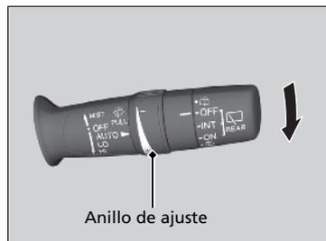
Al bajar la palanca hacia **AUTO**, los limpiaaparabrisas efectúan un barrido y pasan al modo automático.
