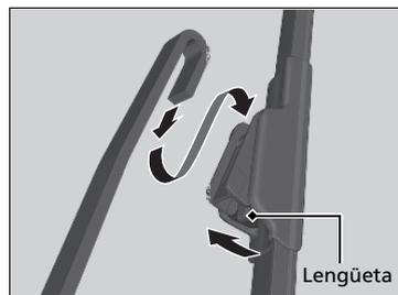
4. Pulse hacia arriba y mantenga pulsada la pestaña y, a continuación, deslice el soporte para sacarlo del brazo del limpiaparabrisas.
