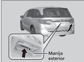
Si presiona la manija exterior del maletero durante menos de un segundo, el maletero se abre automáticamente.
