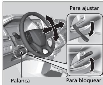
1. Empuje la palanca de ajuste del volante hacia abajo.
