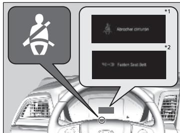
El sistema del cinturón de seguridad incluye un indicador en el tablero de instrumentos para recordar al conductor, al acompañante o a ambos que deben abrocharse los cinturones. Si pasa la modalidad de alimentación a CONTACTO y algún cinturón de seguridad no está abrochado, sonará un aviso acústico y parpadeará el indicador. Pasados unos segundos, el aviso acústico se detendrá y el indicador se encenderá y permanecerá iluminado hasta que se abroche el cinturón de seguridad.
