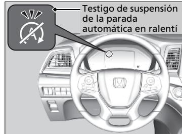
El testigo de suspensión de la parada automática en ralentí se enciende y aparece un mensaje en la interfaz de información al conductor cuando el sistema de parada automática en ralentí no se puede activar.
