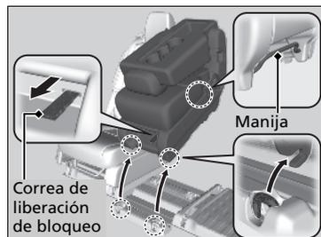
1. Primero guarde el cinturón de seguridad central. Introduzca una llave en la ranura lateral del enganche de anclaje.
