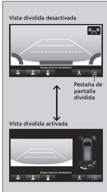
Puede cambiar entre activar y desactivar la vista dividida tocando la pestaña de la pantalla dividida.
