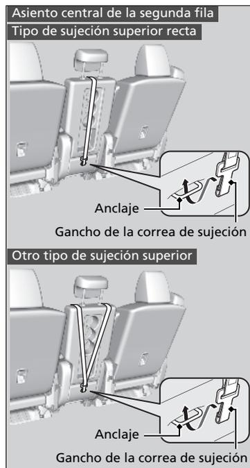
5. Asegúrese de que el sistema de sujeción infantil esté firmemente sujeto; para ello, balancéelo hacia adelante, hacia atrás y a los lados; debe percibirse un movimiento mínimo.
