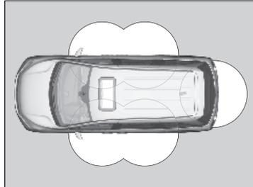
Cuando lleva consigo el control a distancia de acceso sin llave, puede bloquear/desbloquear las puertas, la tapa del depósito de combustible y abrir el maletero.
