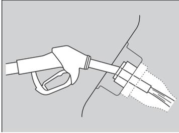
5. Coloque el extremo de la boquilla en la parte inferior de la abertura de llenado y, a continuación, insértelo lenta y completamente.
