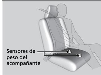
El sistema de airbag frontal avanzado del pasajero dispone de sensores de peso. Los sensores se usan para la clasificación del ocupante, para activar o desactivar el airbag del acompañante.
