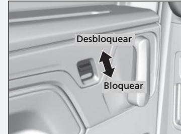
Para abrir la puerta desde el interior cuando el bloqueo de seguridad para niños está activado, coloque la lengüeta de bloqueo en la posición de desbloqueo, baje la ventanilla trasera, saque la mano por la ventana y tire de la manija exterior.
