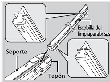
7. Introduzca el lado plano de la nueva escobilla del limpiaparabrisas en la parte inferior del soporte. Inserte completamente la escobilla.
