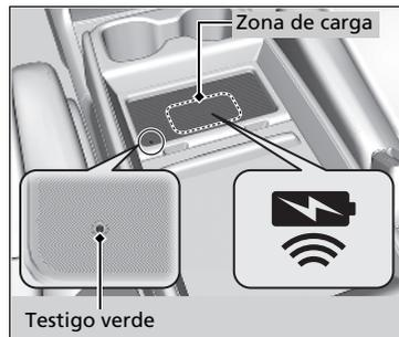
1. Coloque el dispositivo que desea cargar en la zona de carga.
