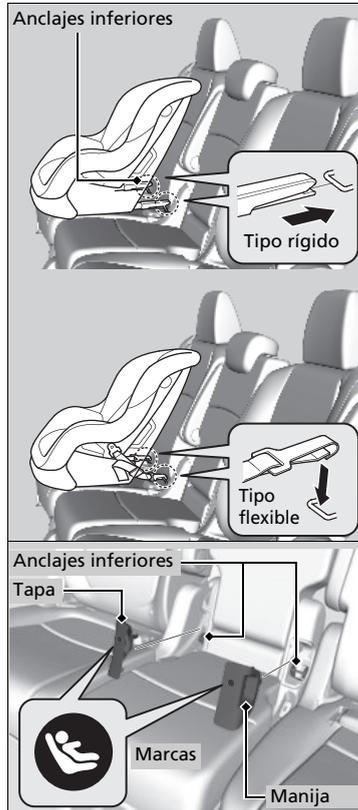
2. Coloque el sistema de sujeción infantil en el asiento del vehículo y, a continuación, fíjelo a los anclajes inferiores según las instrucciones del sistema de sujeción infantil.
