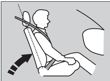
Ajuste el respaldo del asiento del conductor a una posición recta que le resulte cómoda, dejando una amplia separación entre el pecho y la tapa del airbag en el centro del volante.
