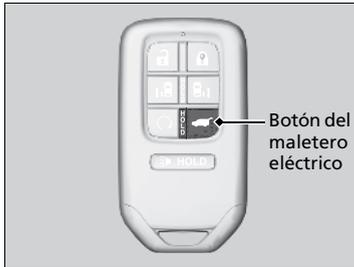
Pulse el botón de la compuerta trasera eléctrica durante más de un segundo para hacerlo funcionar cuando la modalidad de alimentación esté en **VEHÍCULO APAGADO**.
