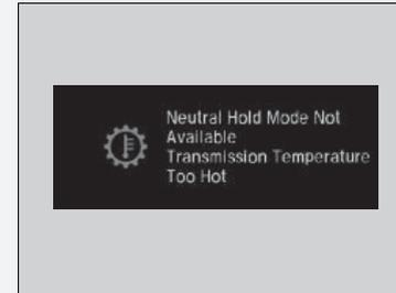
La caja de cambios no debería estar en la posición **[N]** con el siguiente indicador encendido:
