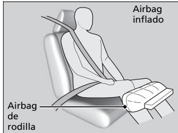
El airbag de rodilla del conductor y el acompañante se despliegan a la vez que los airbags delanteros.
