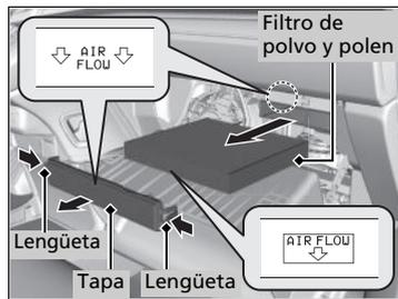
5. Presione las lengüetas de las esquinas de la tapa de la carcasa del filtro y retire la tapa.
