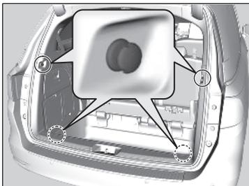
Use los ganchos de equipaje para sujetar el equipaje en el maletero.
