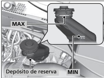
El nivel del líquido debe estar entre las marcas **MIN** y **MAX** en el lateral del depósito de reserva.
