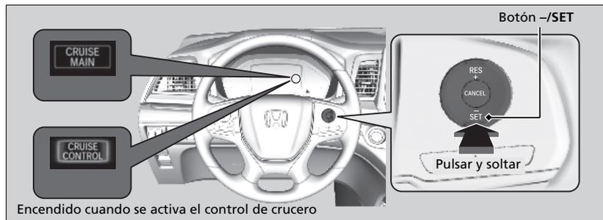
Levante el pie del pedal y pulse el botón **-/SET** cuando alcance la velocidad deseada. En el momento en que suelte el botón **-/SET**, la velocidad quedará fijada y se activará el control de cruce. Aparece **CRUISE CONTROL** en la interfaz de información del conductor.
