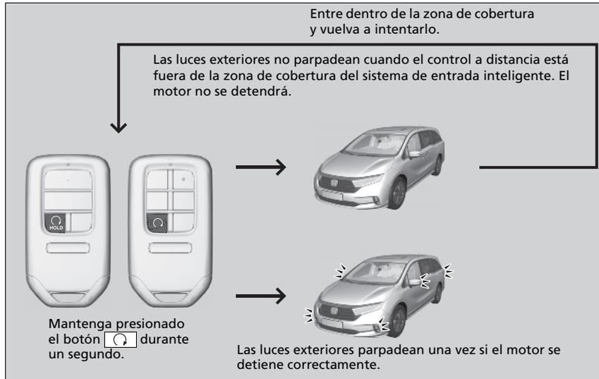
☒ Arranque remoto del motor con información del vehículo\*
