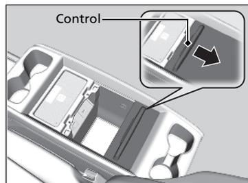
Para abrir el compartimento de la consola, presione el control para desbloquear la tapa y luego deslícela hacia atrás.
