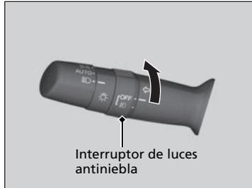
Con las luces de cruce encendidas, active el interruptor de las luces antiniebla para utilizar dichas luces.
