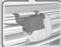
El sistema empieza a supervisar la carretera delante cuando la velocidad de su vehículo es de aproximadamente 5 km/h y hay otro vehículo delante del suyo.
