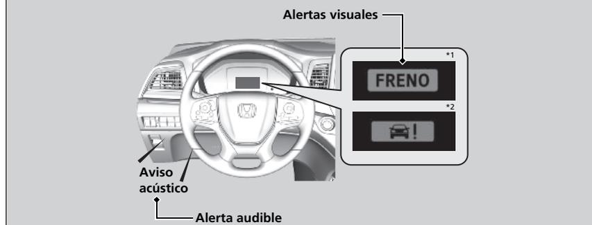
En la fase de alerta de colisión más temprana del sistema, puede cambiar la distancia (**Long/Normal/Corto**) entre vehículos a la que se activan las alertas a través de las opciones de configuración de la pantalla de audio/información.
