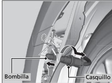
1. Gire el volante por completo hacia el lado opuesto a la luz que va a sustituir.
