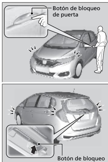
■ **Bloqueo de las puertas y el maletero** Pulse el botón de bloqueo de la puerta delantera o del maletero.
