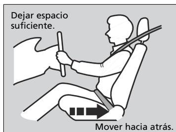
Ajuste el asiento del conductor lo más atrás posible siempre que le permita mantener totalmente el control del vehículo. Deberá poder sentarse con la espalda recta bien apoyada en el respaldo y pisar adecuadamente los pedales, sin tener que inclinarse hacia delante, y agarrar el volante con comodidad. El asiento del acompañante deberá ajustarse de forma similar, para que permanezca lo más alejado posible del airbag frontal en el salpicadero.
