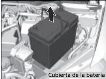
6. Desmonte la cubierta de la batería.
