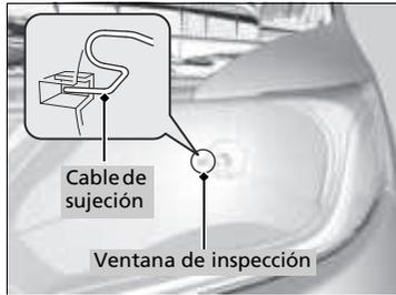
5. Vuelva a instalar el cable de sujeción. Enganche el extremo del cable en la ranura del control.
