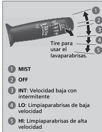
Los limpiaparabrisas y lavaparabrisas se pueden utilizar cuando el interruptor de encendido está en la posición de CONTACTO **II**\*1.
