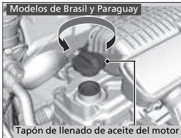
1. Desenrosque y retire el tapón de llenado de aceite del motor.
