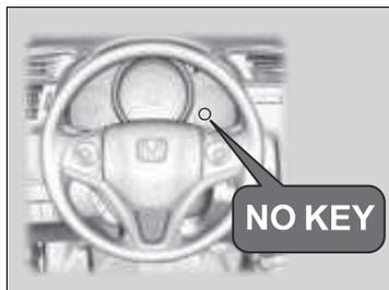
Pueden sonar avisos acústicos de advertencia dentro y/o fuera del vehículo para recordarle que el control a distancia de acceso sin llave se encuentra fuera del vehículo. Si el aviso acústico continúa incluso después de introducir el control a distancia en el vehículo, coloque el control dentro de su alcance de funcionamiento.
