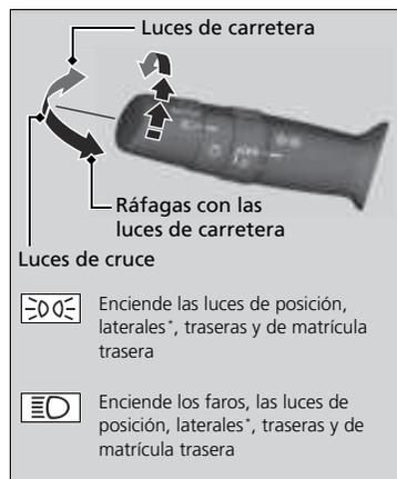
Al girar el interruptor de luces, estas se encienden y se apagan con independencia de la posición del interruptor de encendido.
