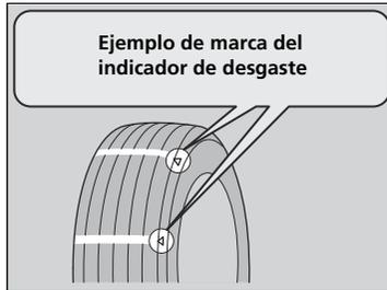
La ranura en la que está situado el indicador de desgaste es 1,6 mm más profunda que cualquier otro punto del neumático. Si la banda está desgastada y el indicador queda visible, sustituya el neumático. **Los neumáticos desgastados presentan una tracción deficiente en carreteras mojadas.**
