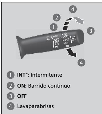
El limpia/lavaparabrisas trasero se puede utilizar cuando el interruptor de encendido está en la posición de CONTACTO **II**\*1.
