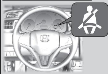
El sistema del cinturón de seguridad incluye un testigo en el tablero de instrumentos para recordar al conductor, al acompañante o a ambos que deben abrocharse los cinturones.
