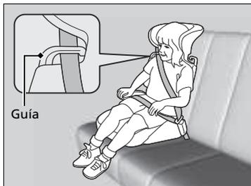
Hay disponible un respaldo para un elevador determinado. Instale el respaldo en el elevador y ajústelo al asiento del vehículo siguiendo las instrucciones del fabricante del elevador. Asegúrese de que el cinturón de seguridad pasa correctamente por la guía del hombro del respaldo y que el cinturón no toca ni cruza el cuello del niño.
