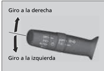
Los intermitentes se pueden utilizar cuando el interruptor de encendido está en la posición de CONTACTO
