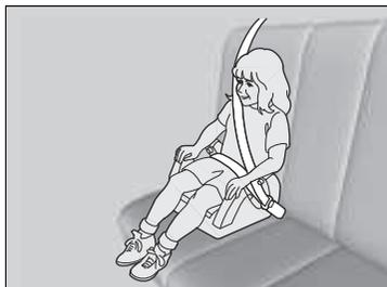
Si no se puede utilizar correctamente un cinturón de seguridad de tres puntos, siente al niño en un cojín elevador en el asiento trasero. Por la seguridad del niño, compruebe que el niño cumple las recomendaciones del fabricante del cojín de seguridad.
