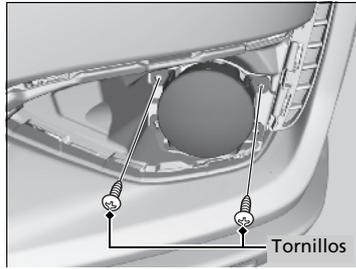
2. Extraiga los tornillos utilizando un desarmador de estrella.
