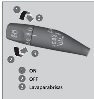
Los limpiaparabrisas y lavaparabrisas se pueden utilizar cuando el interruptor de encendido está en la posición de CONTACTO \*1.
