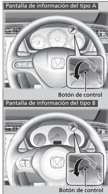
Cuando el brillo del medidor se reduce, se puede utilizar el control de control de brillo para ajustar el brillo del panel de instrumentos.
