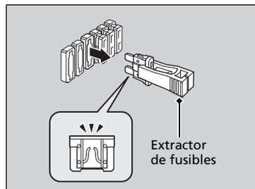
1. Gire el interruptor de encendido a BLOQUEO **0**\*1. Apague los faros y todos los accesorios.
