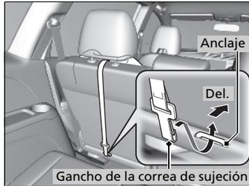
Hay un punto de anclaje para la correa de sujeción detrás de cada asiento exterior de la segunda fila. Si dispone de un sistema de sujeción para niños que incluye una correa de sujeción pero que se puede instalar con cinturón de seguridad, puede utilizar la correa para obtener una mayor seguridad.
