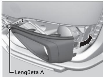
9. Inserte la lengüeta A tal como se muestra y, a continuación, inserte las lengüetas exteriores para instalar la tapa.
