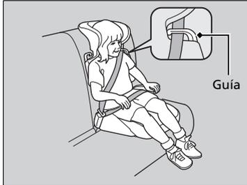
Hay disponible un respaldo para un elevador determinado. Instale el respaldo en el elevador y ajústelo al asiento del vehículo siguiendo las instrucciones del fabricante del elevador. Asegúrese de que el cinturón de seguridad se pasa correctamente a través de la guía del hombro del respaldo y que el cinturón no toca y cruza el cuello del niño.
