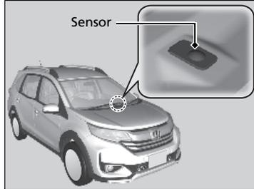
El sistema de aire acondicionado automático está equipado con sensores. No los tape ni vierta líquidos sobre ellos.
