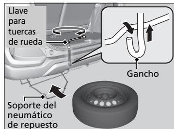
1. Coloque el neumático pinchado boca arriba en el soporte para la rueda de repuesto.
