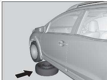
**8.** Coloque el neumático de repuesto (con la llanta hacia arriba) debajo del vehículo, cerca del neumático que va a sustituir.
