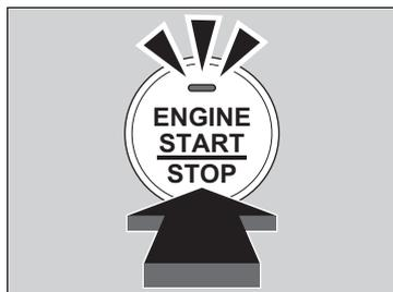
2. Pise el pedal de freno y pulse el botón **ENGINE START/STOP** antes de transcurridos 10 segundos del aviso acústico y de que el indicador cambie de parpadeo a encendido.
