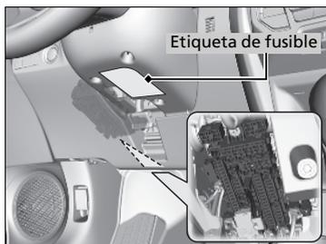
La ubicación de los fusibles se muestra en la etiqueta debajo de la columna del volante. Localice el fusible en cuestión mediante el número del fusible y el número de la etiqueta.
