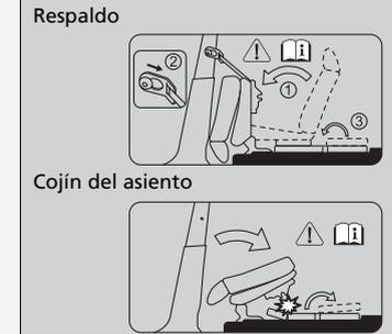
Antes de devolver el asiento a la posición original, almacene la tapa superior de la caja del piso del maletero para evitar que resulte dañada.
