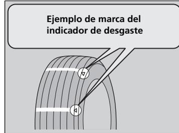
La ranura en la que está situado el indicador de desgaste es 1,6 mm más profunda que cualquier otro punto del neumático. Si la banda está desgastada y el indicador queda visible, sustituya el neumático.
