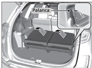
3. Empuje la palanca de ajuste del respaldo hacia abajo.
