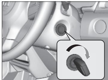
3. Gire el interruptor de encendido a ARRANQUE
