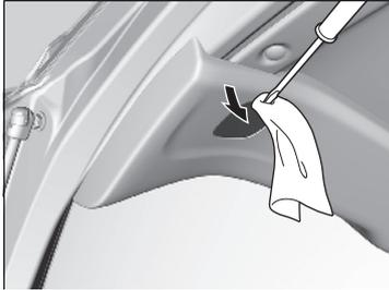
1. Retire la tapa haciendo palanca en el borde con un destornillador de punta plana.
