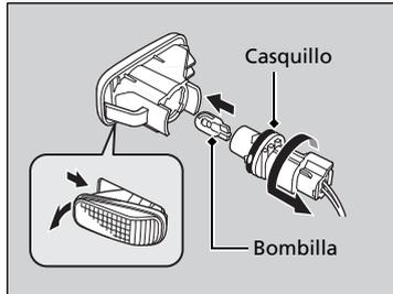
1. Empuje la parte delantera del conjunto de intermitentes laterales hacia la parte trasera del vehículo hasta que salga del armazón.
