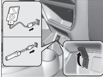
Abra la consola central. Coloque el conector USB del iPod o la unidad de memoria USB en el puerto USB.
