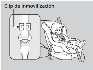
Si el sistema de sujeción para niños no dispone de un mecanismo de sujeción del cinturón, instale un clip de inmovilización en el cinturón de seguridad.
