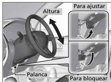
1. Tire de la palanca de ajuste del volante hacia arriba.
