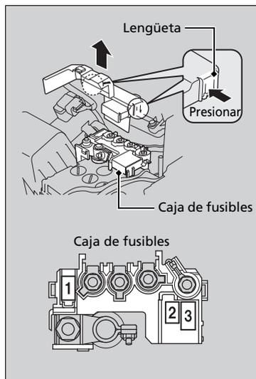
Las ubicaciones de los fusibles se muestran en la cubierta de la caja de fusibles.
