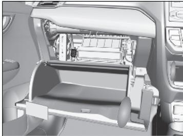
4. Localice la caja de fusibles junto a la unidad del sistema de aire acondicionado.
