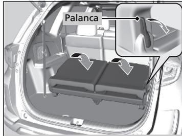
1. Pliegue los respaldos hacia delante.
