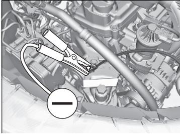
4. Conecte el otro extremo del segundo cable de arranque al punto de toma a tierra del motor como se muestra. No conecte este cable de arranque a ninguna otra parte.
