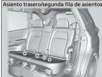
Los asientos exteriores de la segunda fila de asientos tienen cinturones de seguridad de tres puntos. La posición central tiene un cinturón de cadera o un cinturón de seguridad de tres puntos.
