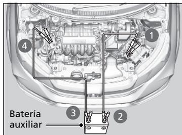
1. Conecte el primer cable de arranque al terminal  $\oplus$  de la batería del vehículo.
