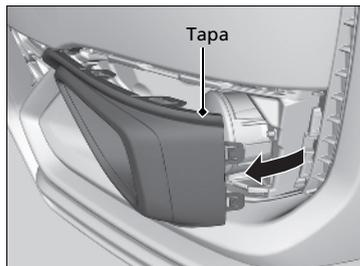
1. Haga palanca en la ranura del borde entre el parachoques y la tapa con un desarmador de punta plana para desmontarla.
