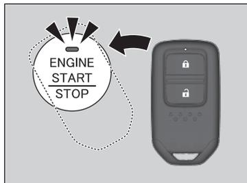
1. Toque la parte central del botón **ENGINE START/STOP** con el símbolo **H** del control a distancia de acceso sin llave mientras parpadea el indicador del botón **ENGINE START/STOP**. Los botones del control a distancia de acceso sin llave deben estar orientados hacia usted.
