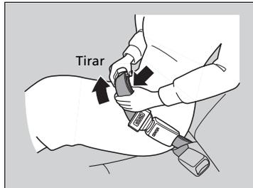
**1.** Sujetar la hebilla perpendicular al cinturón tensado. La longitud del cinturón es ajustable.
