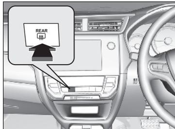
Pulse el botón del desempañador trasero para desempañar la luneta con el interruptor de encendido en la posición de CONTACTO
