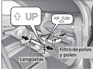
4. Presione las lengüetas de las esquinas de la carcasa del filtro. Extraiga la carcasa.
