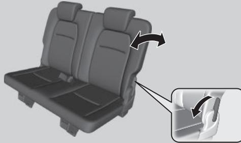
**Palanca de ajuste de la inclinación del respaldo/plegado**
