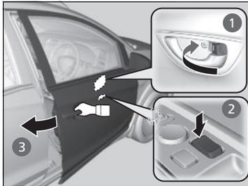
■ **Bloqueo de la puerta del conductor** Empuje la lengüeta de bloqueo hacia delante ① o empuje el interruptor de bloqueo principal de las puertas en la dirección de bloqueo ② y después mantenga estirada la manija exterior de la puerta. Cierre la puerta ③ y suelte la manija.
