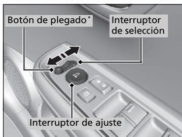
Solamente puede hacer funcionar los retrovisores con el interruptor de encendido en la posición de CONTACTO **II**\*1.
