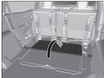
7. Abra la tapa superior de la caja del piso del maletero por encima del piso trasero para que quede plano.
