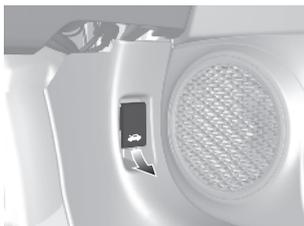
**2** Localice la palanca del cerrojo del cofre, empujela hacia el lado y levante el cofre. Una vez levantado el cofre ligeramente, puede soltar la palanca.
