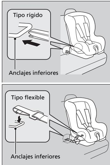
3. Coloque el sistema de sujeción para niños en el asiento del vehículo y después fíjelo a los anclajes inferiores según las instrucciones del sistema de sujeción para niños.
