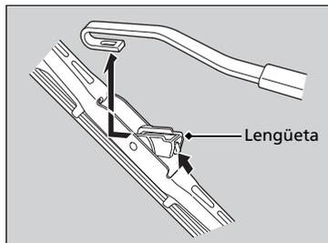
1. Levante primero el brazo del limpiaparabrisas del lado del conductor y después el del lado del acompañante.
