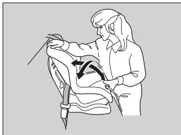
6. Asegúrese de que el sistema de sujeción infantil esté firmemente sujeto balanceándolo hacia delante, atrás y lateralmente; deberá notarse poco movimiento.
