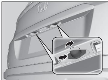
1. Pulse el borde izquierdo de la lente hacia la derecha y retire el conjunto de la luz de matrícula.
