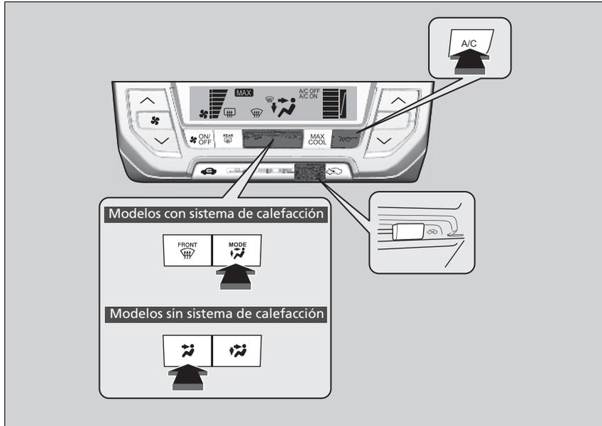
1. Ajuste la velocidad del ventilador con la barra de control del ventilador.
