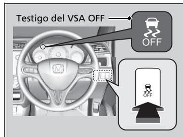
Este botón se encuentra en el panel de controles del lado del conductor. Para desactivar parcialmente la función/características de VSA, mantenga pulsado hasta que escuche un aviso acústico.
