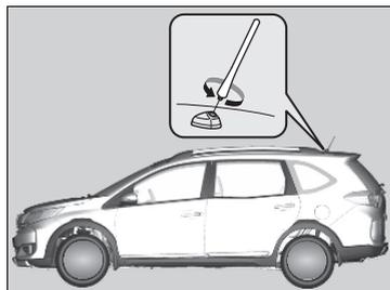
El vehículo está equipado con una antena desmontable en la parte trasera del techo.
