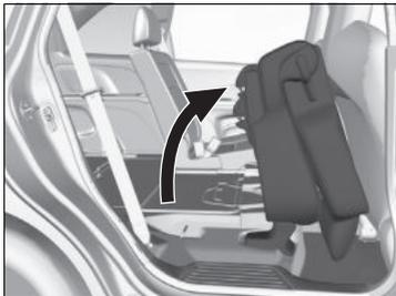
1. Pliegue el respaldo hacia delante.
