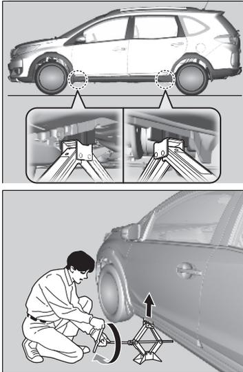
1. Coloque el gato debajo del punto de apoyo más cercano al neumático que va a cambiarse.
