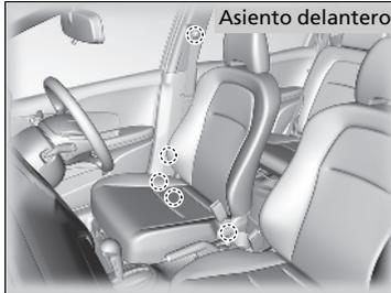
Al sustituir los cinturones de seguridad, utilice los puntos de anclaje que se muestran en las imágenes. El asiento delantero tiene un cinturón de seguridad de tres puntos.
