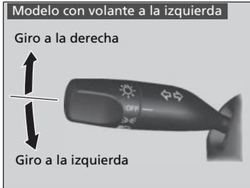
Los intermitentes se pueden utilizar cuando el interruptor de encendido está en la posición de CONTACTO
